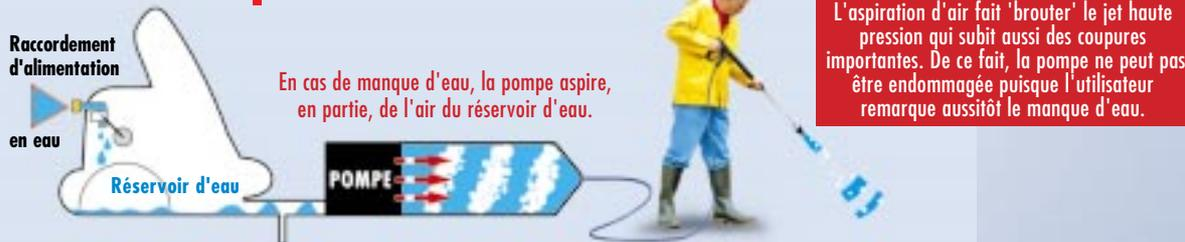
L'aspiration d'air fait 'brouter' le jet haute pression qui subit aussi des coupures importantes. De ce fait, la pompe ne peut pas être endommagée puisque l'utilisateur remarque aussitôt le manque d'eau.
